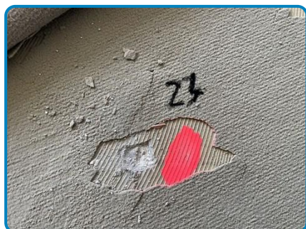
Prélèvement n° 24 : Sol Lé vinyle collé Ragreage colle (dans Batiment 1 MDH inoccupé RDC R009)
